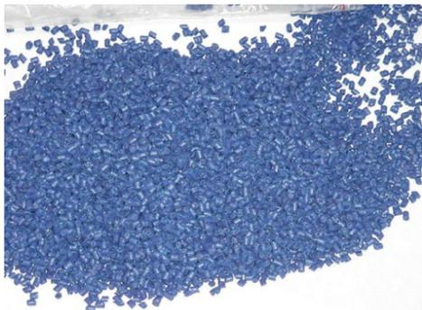
VAPPRO MBR 1000 é um masterbatch de aditivo VCI em polietileno linear de baixa densidade. Contém um composto VCI que confere propriedades de proteção contra corrosão em filmes de polietileno.
