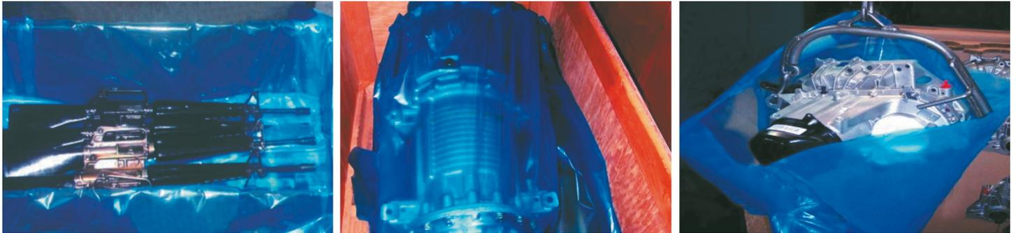
O FILME VCI VAPPRO 826 é um avanço significativo na tecnologia de embalagem protetora. Ele oferece um novo conceito de proteção do produto sem a necessidade do uso de revestimentos preventivos de oxidação oleosos. Oferece proteção para ligas de alumínio, latão e cobre, proporcionando uma excelente proteção para metais ferrosos como aço e aço inoxidável. Não altera propriedades críticas elétricas ou mecânicas de componentes eletrônicos ou elétricos.
